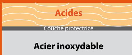
Lorsqu'un acier inoxydable est placé en contact prolongé avec un acide fort, la couche protectrice formée à la surface de l'acier inoxydable se dissout rapidement.
