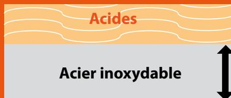
L'acier inoxydable n'est alors plus protégé et il y a attaque de toute la surface avec souvent formation de rouille de couleur rouge, marron ou noire et diminution de l'épaisseur jusqu'à percement complet.
